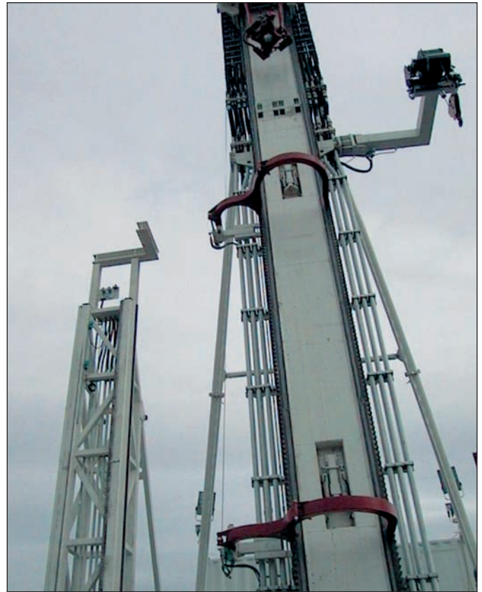
Lumiglas-VISULEX-Ex-Kamera-System an einem Bohrgestänge
