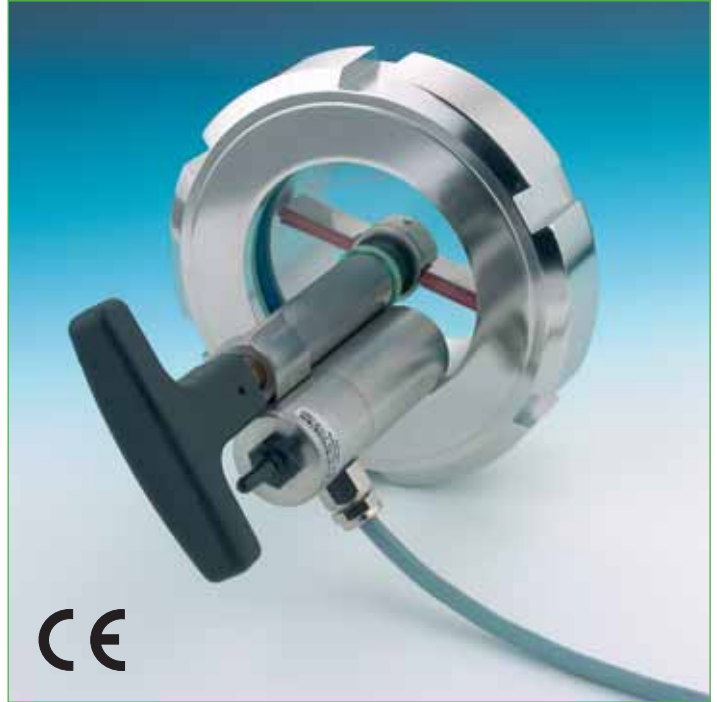
Edelstahl Mini-Lumiglas-Leuchte USL01 mit Befestigungsklammer im Einsatz auf einer Schraub-Schauglas-Armatur mit Lumiglas-Scheibenwischer, Typ SW I (Klemmbefestigung am Scheibenwischer)
